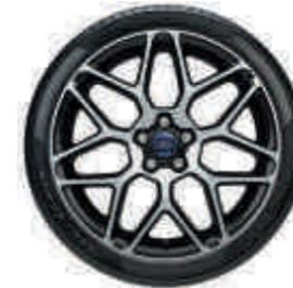
19" 7x2-lúčové disky kolies z ľahkých zliatin s povrchovou úpravou Shadow Black pre Titanium (na želanie)
